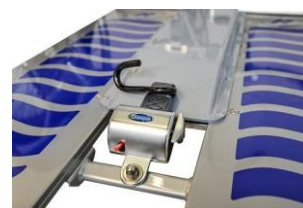
Fijación de rampa
